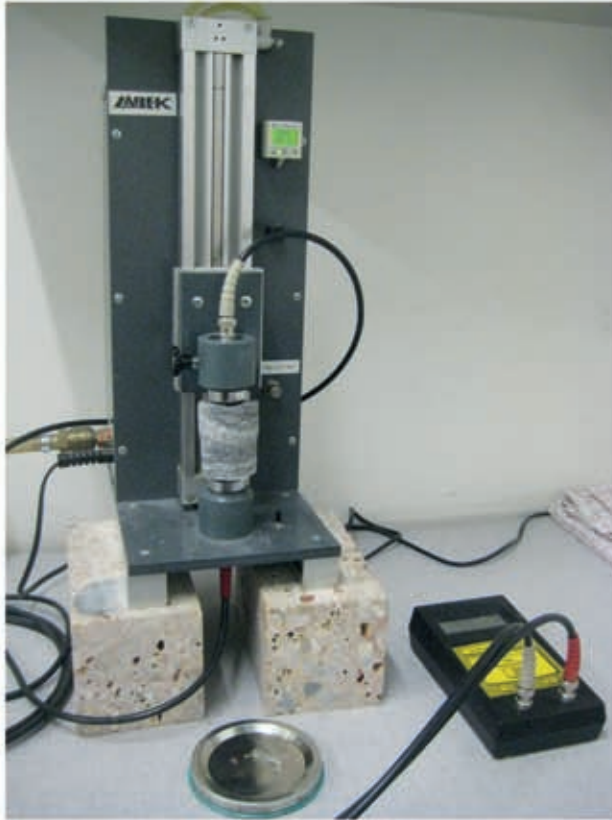
1 Ultraschallmessgerät ATH-MA C369 in der stationären Prüfeinrichtung der Technischen Universität Wien
