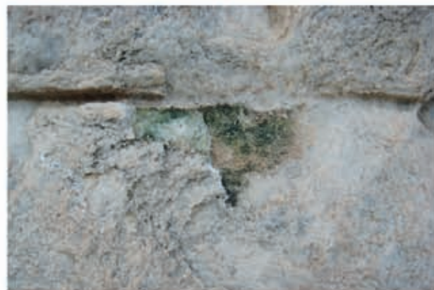
6 Cyanobakterien im gestörten Gefüge mit großen Rissweiten, 027S , Probe HTEMP 26
