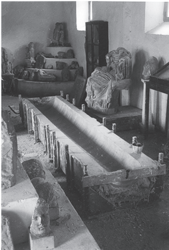
1 Eine Hälfte der Säulenform: Gipsform in einer hölzernen Rahmenkonstruktion
