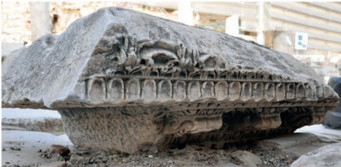
2 Schrägeison 055G in Bodenlagerung: verstärkte Besiedlung durch Mikroorganismen und reduzierte Krustenbildung in den Regenschattenzonen
