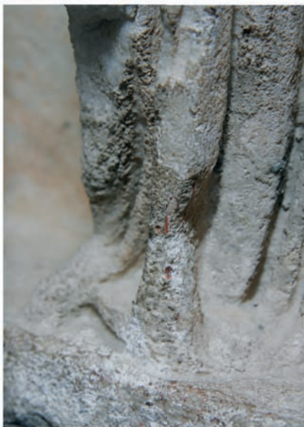
3 Detail eines Fußpaares von Friesblock 716 : rot gefärbte Schicht unterhalb der historischen Krustenbildung
