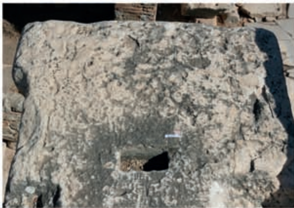
3 Durch Mikroorganismen dunkel gefärbte Bereiche einer horizontalen Marmoroberfläche ( 094G )
